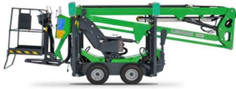
Der LEGUAN 135 ist eine moderne Hubarbeitsbühne für den professionellen Einsatz. Die robuste Konstruktion, die lange Lebensdauer und die einfache und die sichere Handhabung sowie die Ausstattung mit dem äußerst geräuscharmen Honda iGX390 Benzinmotor mit automatischer Gas – und Chokesteuerung bieten viele Einsatzmöglichkeiten auch in der Vermietung.
